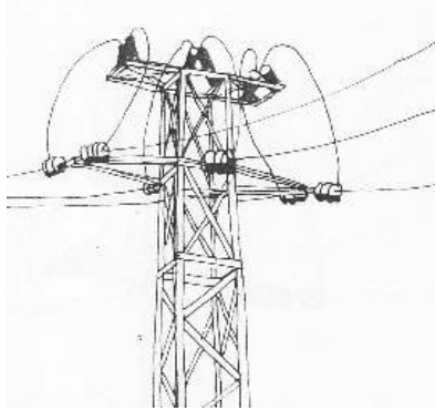
Figura 4. Poste con seccionador tripolar en cabecera
